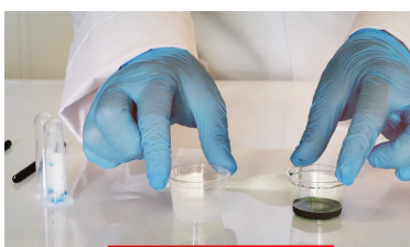
Påvisning av karbondioksid med kalkvann
